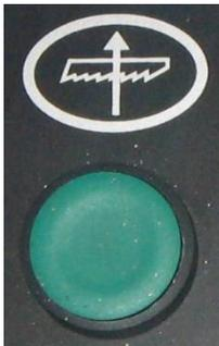
Функцией этой кнопки является подъём верхней головки, пока нажат переключатель верхнего предела. Когда верхний концевой выключатель работает, головка перестаёт подниматься вверх.
