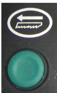
Эта кнопка обеспечивает запуск ведущего двигателя ленточной пилы, подавая питание. Затем открывается клапан регулировки скорости и
