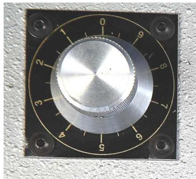
Отрегулируйте скорость резки и скорость опускания головки в зависимости от количества пыли, появляющейся в процессе резки.
