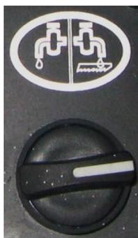
В открытом положении этой кнопки, насос жидкости запускается и смазочно-охлаждающая жидкость перекачивается на материал. Ленточная пила запускается после нажатия кнопки запуска.
