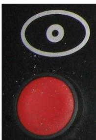
Эта кнопка обеспечивает остановку ведущего двигателя ленточной пилы. В случае остановки двигателя необходимо его заново запустить, проверяется, если верхняя головка, будучи свободной от верхнего концевого выключателя и головка поднимается до включения кнопки поднятия головки и затем кнопка запуска
