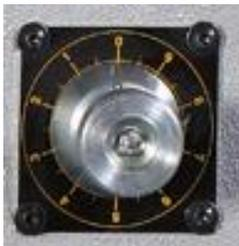
Используется для регулировки скорости опускания головки. Её можно заблокировать в случае необходимости. Правильная скорость опускания головки выбирается в зависимости от формы стружки.
