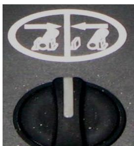
Захват и выпуск материала осуществляется с помощью этой кнопки. Для хорошей работы этой кнопки, переключатель верхнего предела должен быть в эксплуатации. Имеется ввиду, что верхняя головка станка должна быть поднята.
