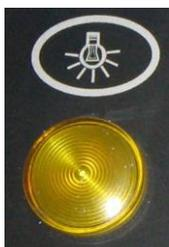
Эта лампочка загорается, когда термическое оборудование электродвигателя выходит из строя и момент поломки станок останавливается. Рекомендуется произвести сброс всех настроек
