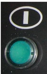
Эта кнопка подаёт электричество на другие кнопки панели. Когда аварийная кнопка включена и лампочка индикатора светится, кнопка запуска нажимается и зелёная ламочка внутри этой кнопки загорается. В этом случае остальные кнопки на панели готовы к функционированию. При нажатии аварийной кнопки, кнопка запуска не работает.
