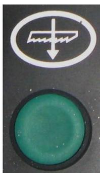
В случае, если эта кнопка нажата, верхняя головка станка начинает опускаться, если клапан регулировки скорости открыт. Для этого кнопка должна быть нажата и ленточная пила не должна
